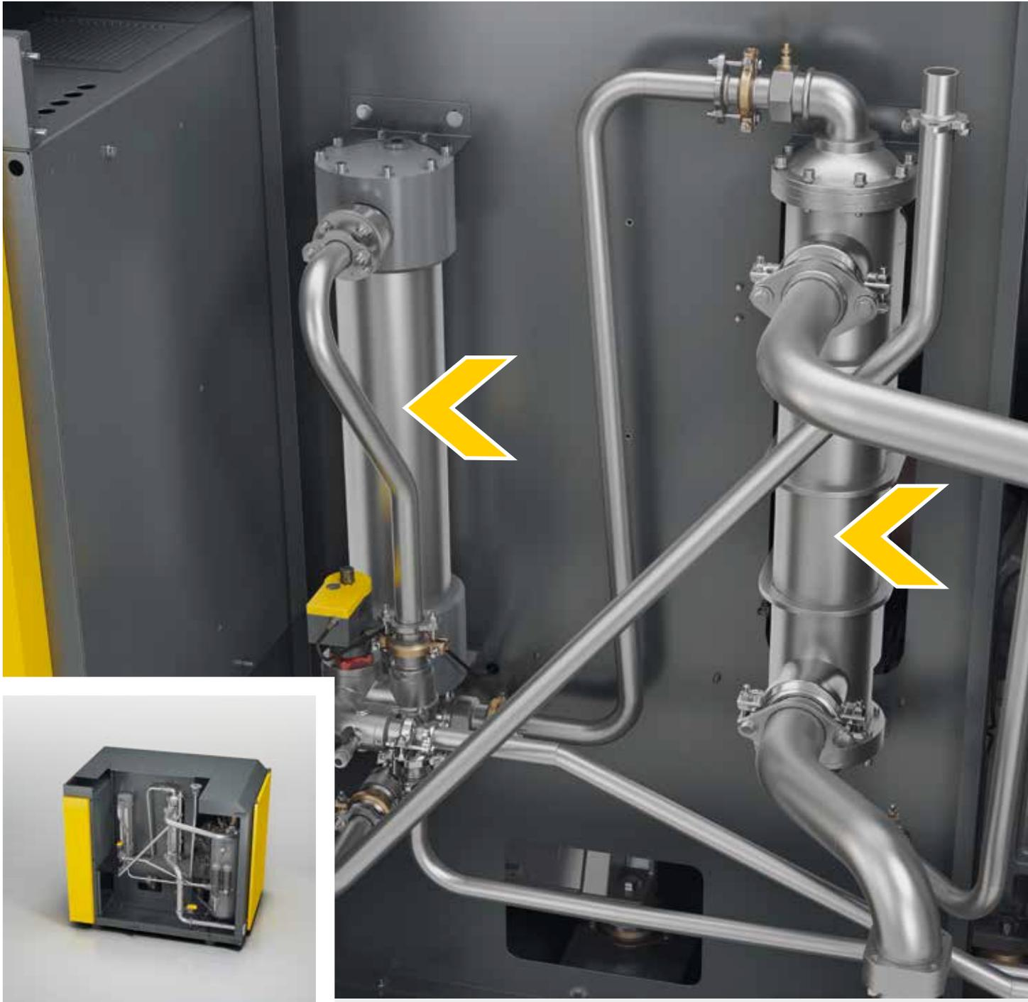
Rohrbündel-Wärmetauscher aus Kupfer-Nickel-Legierung (CuNi10Fe) sind bei Plattenwärmetauschern adäquater Kühlleistung weniger verschmutzungsanfälliger, jedoch deutlich robuster und mechanisch reinigbar. Desweiteren lassen sich die Kühlereinsätze sehr einfach wechseln.
