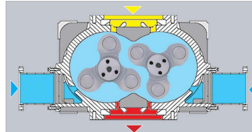
Ist das Vakuum (gelb) zwischen Rotor und Gehäuse eingeschlossen, dringt bei weiterer Drehung der Rotoren über sogenannte Voreinlasskanäle Umgebungsluft (blau) in den Gebläseblock ein. Die aus dem Vakuum und der Umgebung stammenden Volumenströme vermischen sich, und die entstehende Verdichtungswärme verteilt sich auf die um ein Vielfaches größere eingeschlossene Luftmasse. So lassen sich die gleichen Verdichtungsendtemperaturen wie mit normalen Gebläseblöcken erreichen.
