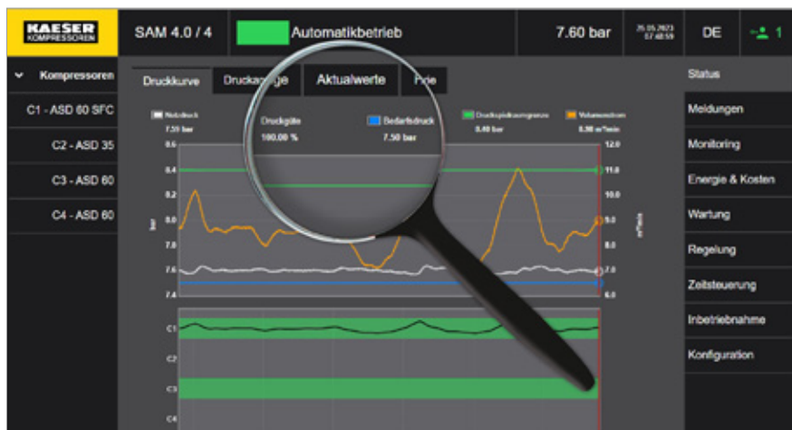
Abb. 5b: Volumenstrom- und Druckverlauf mit Überwachung der Druckgüte
