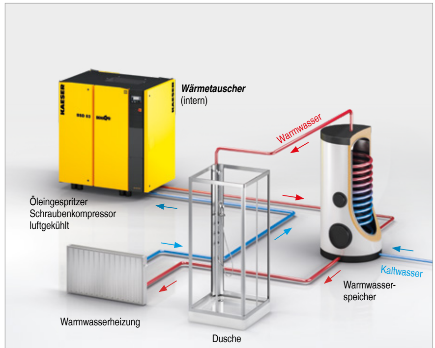
Abb. 3: Schema Wärmerückgewinnung für die Warmwassernutzung
