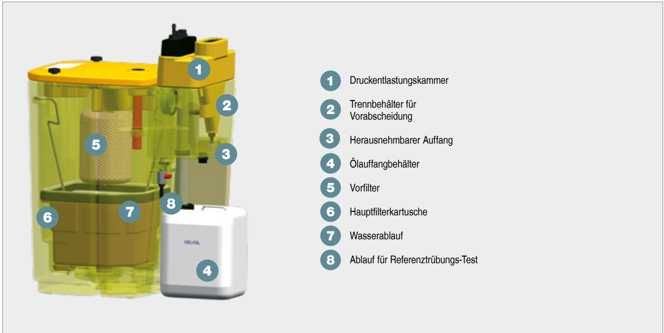
Abb. 3: Kondensattrennsystem für Druckluft-Kondensat nach dem Schwerkraftprinzip (Funktionsbild)
