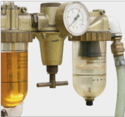
Abb. 6: Wartungseinheit mit Druckminderer
