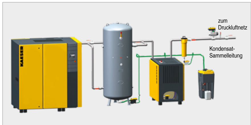
Abb. 1: In jedem Druckluftsystem fällt an bestimmten Stellen Kondensat an
