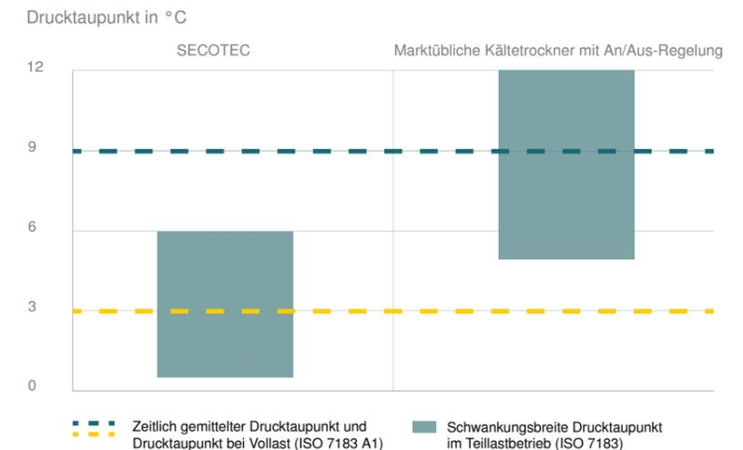
SECOTEC-Kältetrockner arbeiten hingegen aufgrund der hohen Kältespeicherkapazität besonders materialschonend. Ist der Speicher einmal geladen, können Kältekompressor und Lüftermotor deutlich länger ausgeschaltet bleiben, ohne die Drucktaupunkt-Stabilität zu beeinträchtigen.
