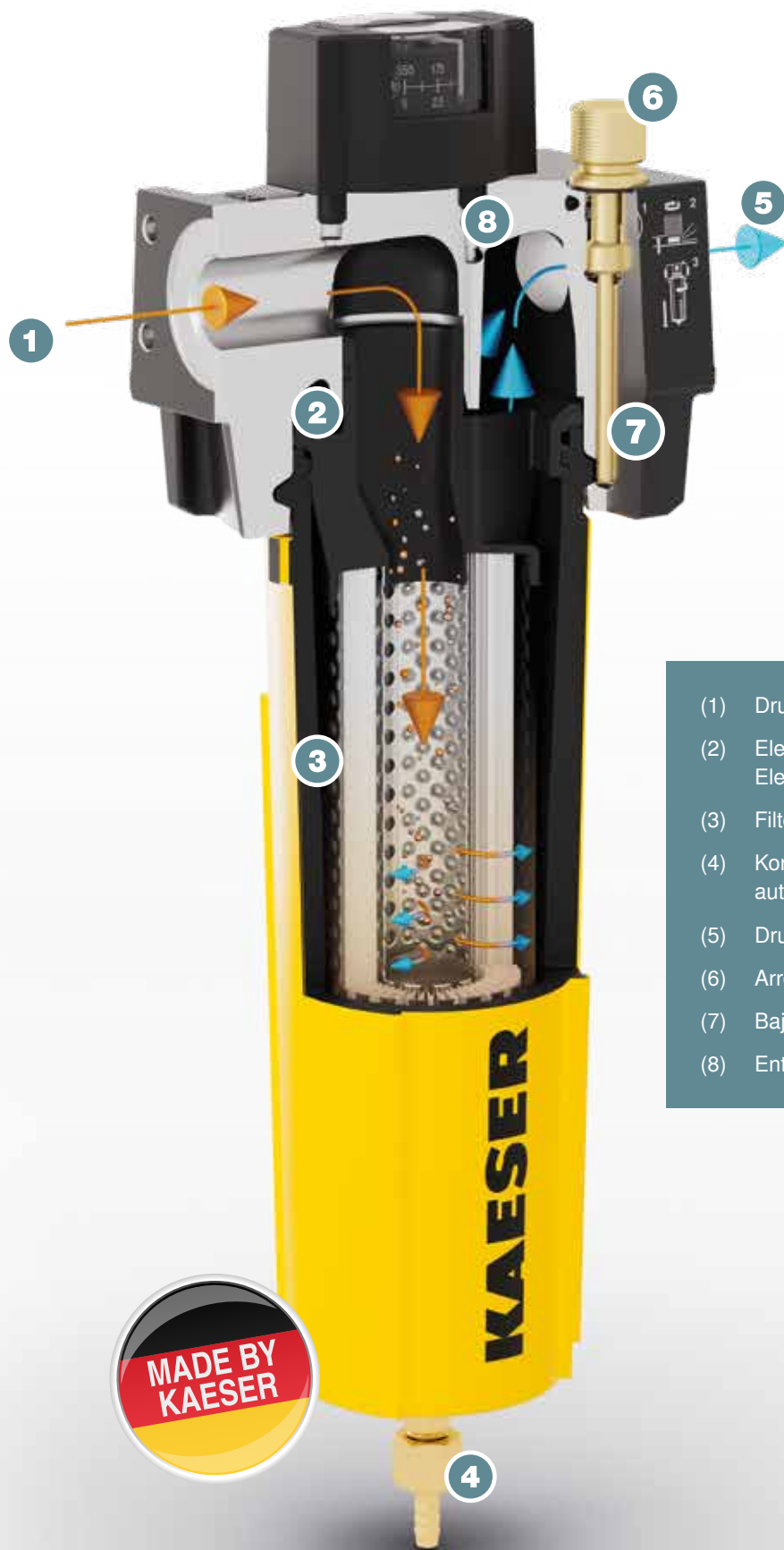
Abb.: Funktionsschema Koaleszenzfilter
