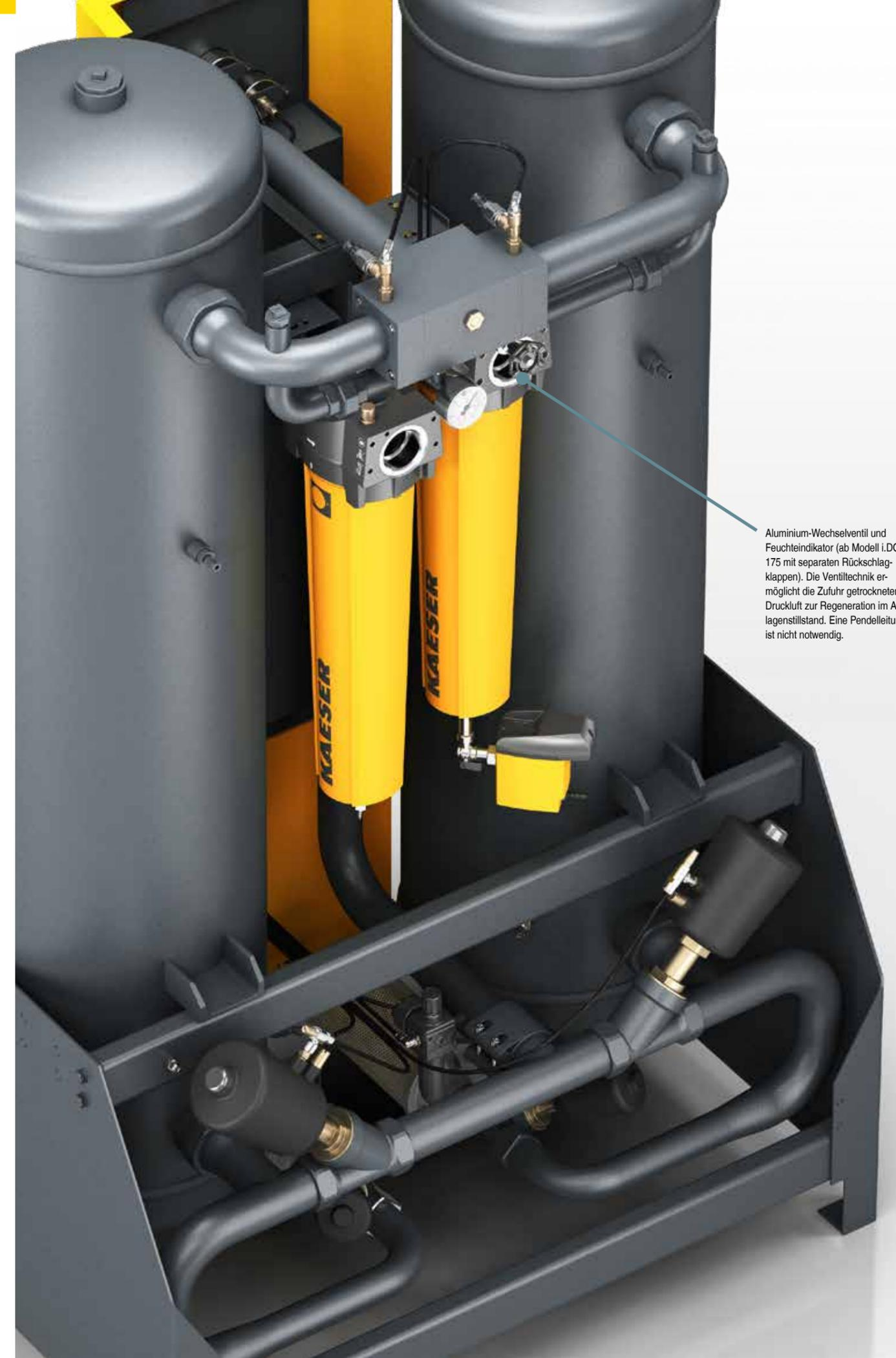
Aluminium-Wechselventil und Feuchteindikator (ab Modell i.DC 175 mit separaten Rückschlagklappen). Die Ventiltechnik ermöglicht die Zufuhr getrockneter Druckluft zur Regeneration im Anlagenstillstand. Eine Pendelleitung ist nicht notwendig.
